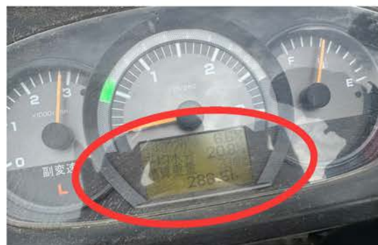
コンバインに運転席モニターに表示される 「平均タンパク質含有率、水分含有率、積算重量」 スマホアプリからも本データの確認可能！
